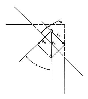
FIGURE 2.7 FORCE COMPONENTS IN OBLIQUE COLLISION
